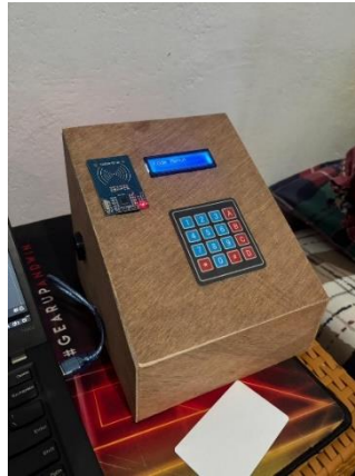
Gambar 10. Tampilan Fisik Prototipe Sistem Pemesanan Makanan Berbasis IoT
