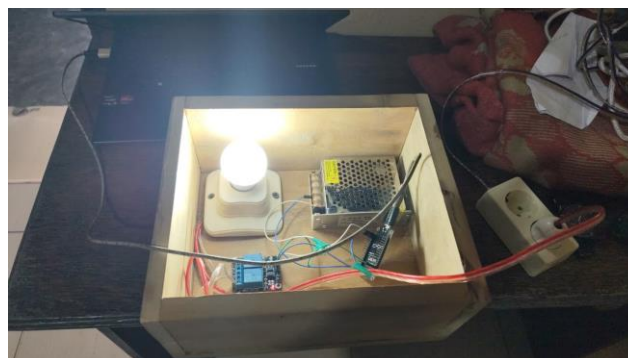
Figure 3. Sistem Kontrol Lampu Jarak Jauh
