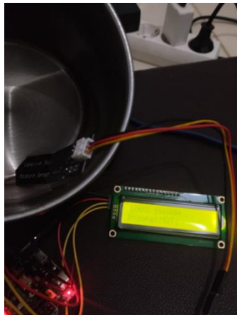
Gambar 6. Sensor Kelembapan pada Kondisi Basah
